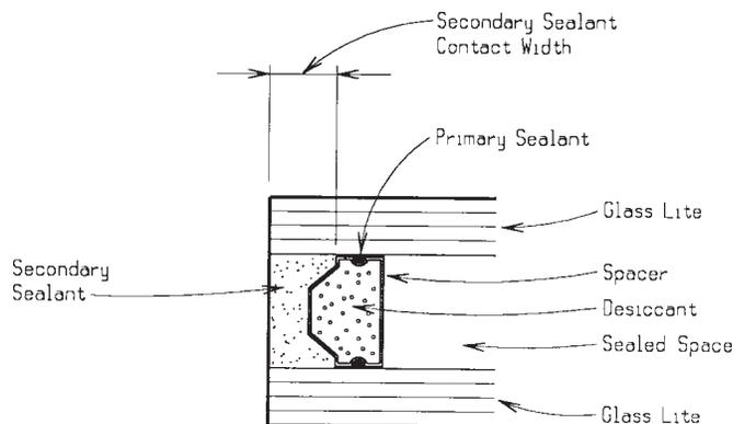
FIG. 1 Sealed IG Edge Seal: Basic Components
